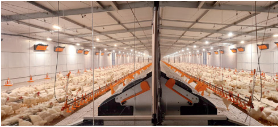
給餌中のブロイラー種鶏舎の様子：吊り下げ式チェーン給餌システム
