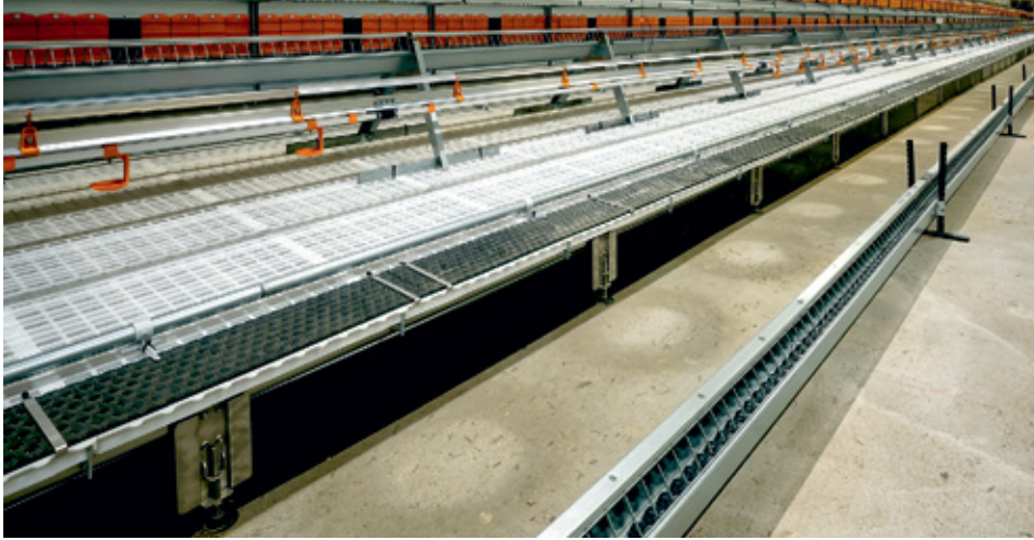
ジャンプ高わずか280mm：スノコ下に設置する巻取り式糞尿搬出システム
